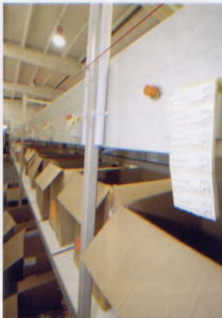
■ Il classificatore può gestire 160 modelli distinti. Inserisce in ciascuna cassa 4 modelli che verranno successivamente separati manualmente. Il software di gestione del classificatore è stato sviluppato appositamente perché le esigenze possano essere le più differenti a secondo dei vari clienti. □ The classifier can manage 160 separate models. It inserts four models into each crate, which are later separated by hand.
